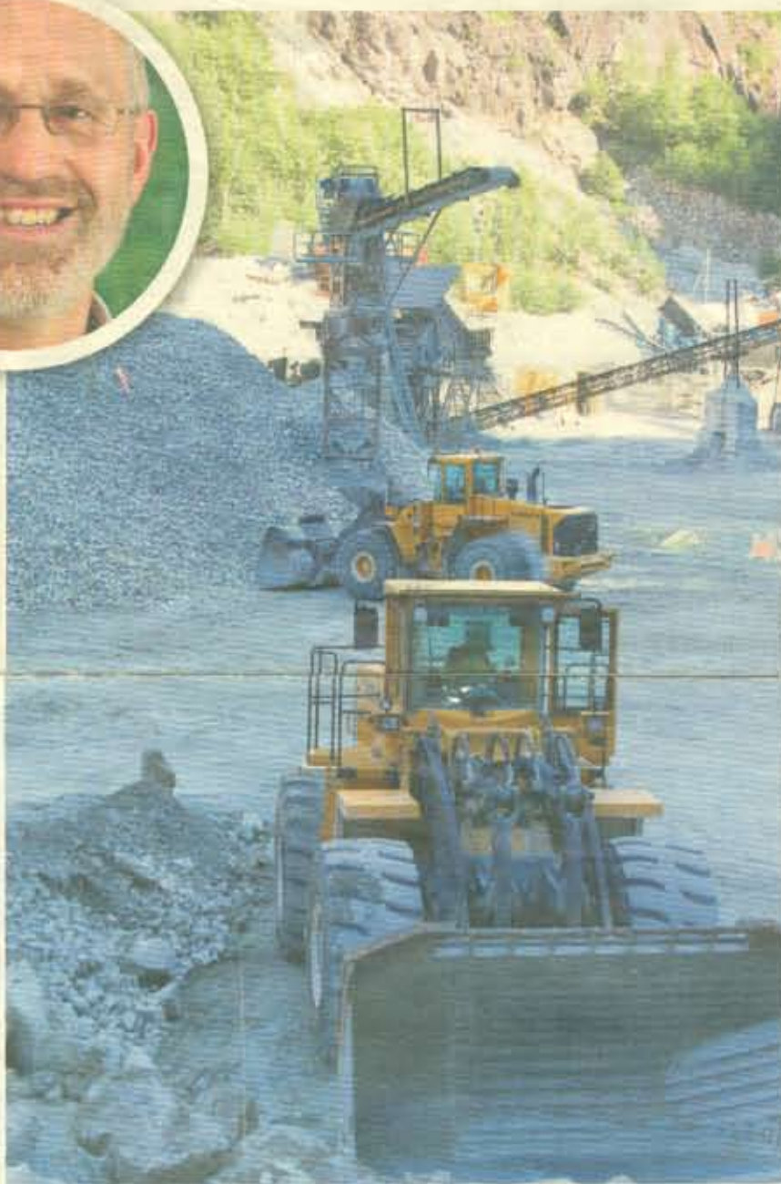
Steenmeel wordt via open mijnbouw gewonnen uit vulkanisch gesteente. Inzet boven: Bert Capay, onder: Huig Bergsma. Foto's Arcadis
